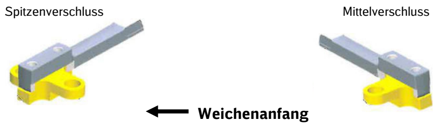
Bild 19 Montage der Seitenanriffe bei Weichen mit Verschlusschwellen
