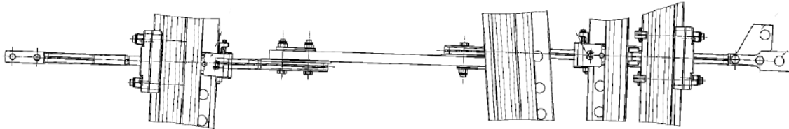
Bild 7 Ausgleich des Versatzes der Zungenbohrungen bei Kreuzungsweichen
