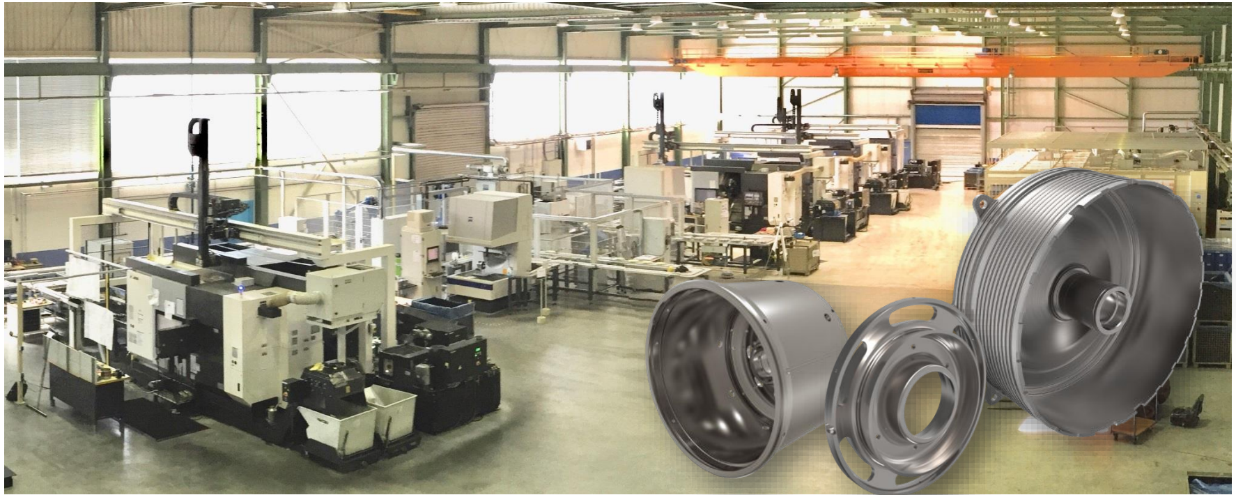
■ Komplette Stadienfolge Rotorwelle BMW i3
