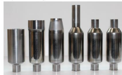
■ Komplette Stadienfolge Rotorwelle BMW i3
